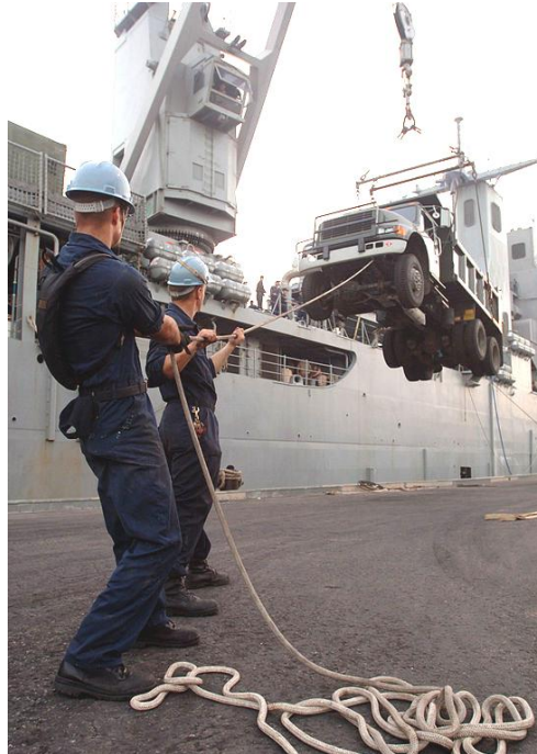
FIGURA 12: TRABALHADORES USANDO CABOS DE MANOBRA PARA GUIAR A CARGA DURANTE UMA OPERAÇÃO DE ELEVÇÃO
