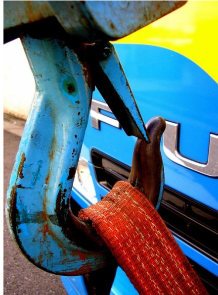
FIGURA 11: GANCHO DO GUINDASTE COM A TRAVA DE SEGURANÇA FECHADA. FOTO POR TANAKAWHO, CC-BY 2.0
